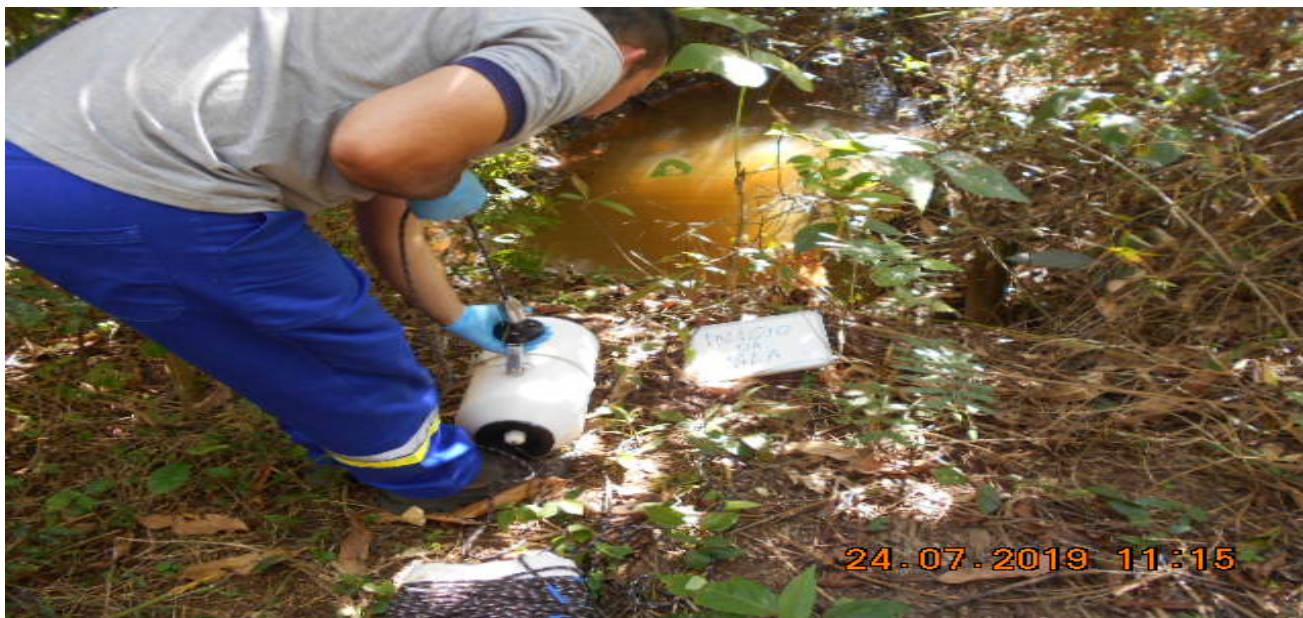
Figura 1: Garrafa de Van Dorn de fluxo horizontal utilizada no processo de amostragem.
